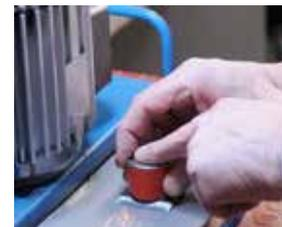
Affiliamo qualsiasi lama. Per affilare una lama di una tosatrice si utilizza un' affilatrice particolare con la forma di una specie di giradischi.
